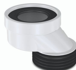
art. MEP6000 WC manžeta pevná excentrická 60 mm DMOC 89 Kč balení 6 ks materiál PP/TPE
