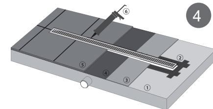
CZ 1 beton 2 hydroizolační páska 3 hydroizolační hmota 4 lepidlo, dlažba, sanitární silikon
